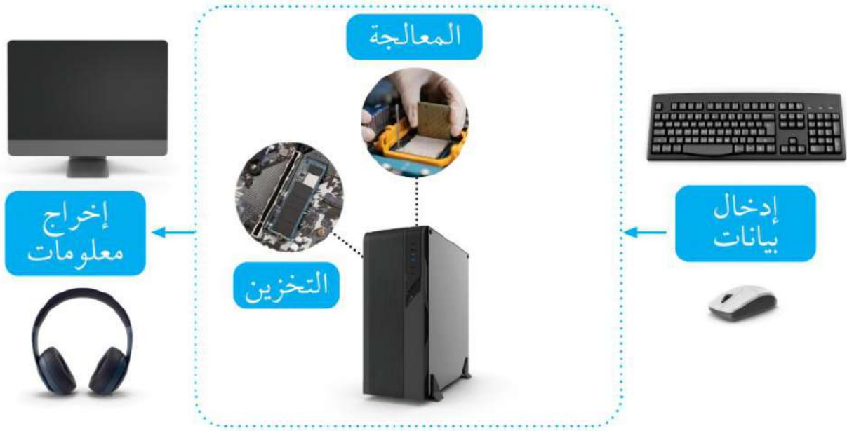
الشكل (1-1): رسم توضيحي لمبدأ عمل جهاز الحاسوب.
